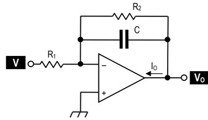
Corretto funzionamento:  $|V_o| < V_{SAT}$  ;  $|I_o| < I_{O\_MAX}$
