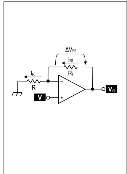
**NOTA 1. Impossibilità di realizzare un attenuatore.** L'amplificatore non invertente ha un guadagno sempre maggiore o uguale a 1, pertanto non permette di realizzare l'attenuazione del segnale di ingresso.
