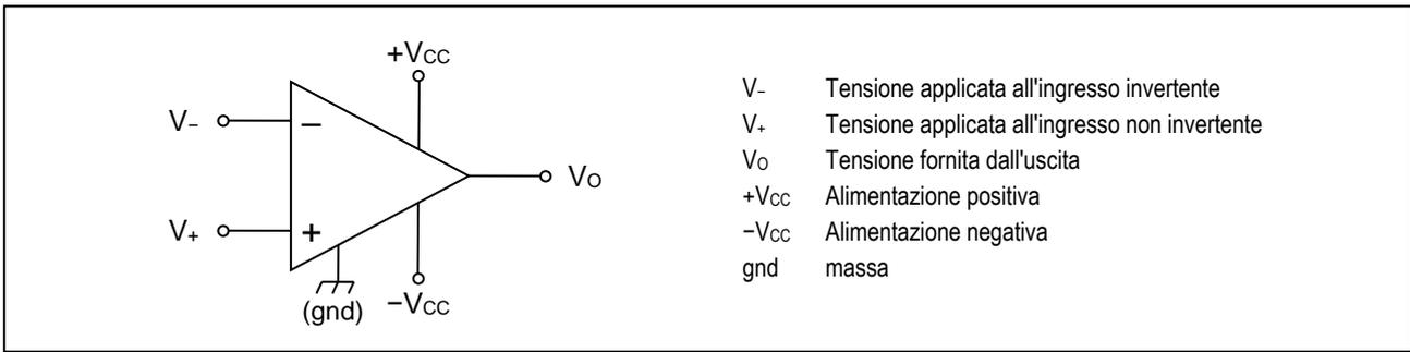
Le caratteristiche dell'AO ideale possono suddividersi in due gruppi: le *proprietà elettriche* e i *limiti di funzionamento*.
