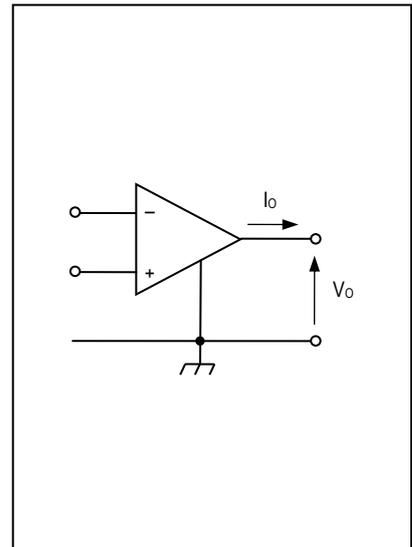
**NOTA. Considerazioni sul calcolo della  $I_{O\_MAX}$ .** Nella progettazione di circuiti elettronici con AO occorre sempre controllare che non vengano superati i limiti di tensione e di corrente appena definiti. Tuttavia nei circuiti di segnale il controllo sulla corrente di uscita viene spesso omesso in quanto le correnti circolanti in questo tipo di circuito sono molto basse, e quindi il limite sulla corrente di uscita viene sempre soddisfatto.
