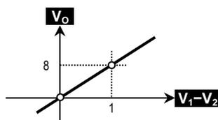
da cui l'equazione  $\rightarrow V_O = 8 \cdot (V_1 - V_2)$
