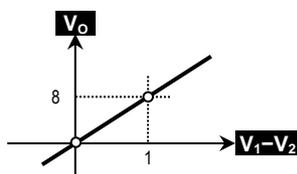
da cui l'equazione  $\rightarrow V_O = 8 \cdot (V_1 - V_2)$
