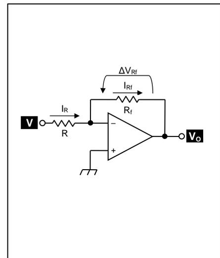
**NOTA. La versatilità dell'amplificatore invertente.** Il circuito dell'amplificatore invertente è molto versatile, infatti può realizzare le seguenti funzioni:
