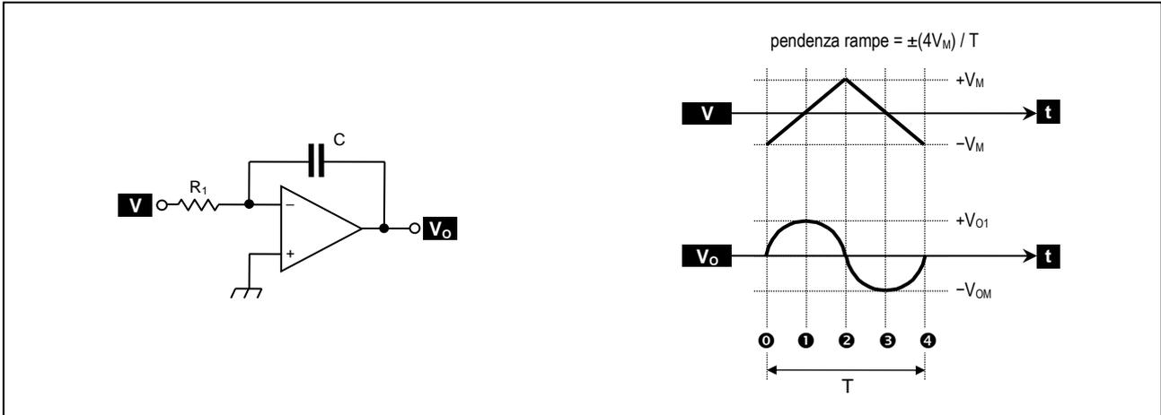
Consideriamo come funzione di ingresso V un'onda triangolare simmetrica con periodo T, dc=0,5 e ampiezza VM. Poichè la V può essere pensata come una successione di rampe, di conseguenza la funzione di uscita VO è formata da una successione di archi di parabola:
