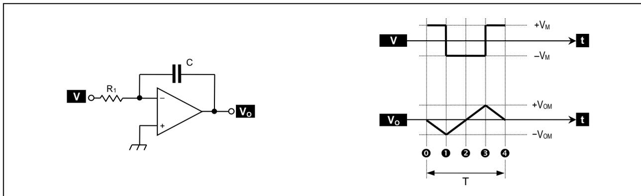
Consideriamo come funzione di ingresso  $V$  un'onda quadra simmetrica con periodo  $T$ ,  $dc=0,5$  e ampiezza  $V_M$ . Poichè  $V$  può essere pensata come una successione di gradini, di conseguenza la funzione di uscita  $V_O$  è formata da una successione di rampe:
