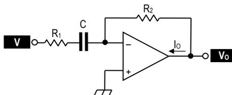
Corretto funzionamento:  $|V_O| < V_{SAT}$  ;  $|I_O| < I_{O\_MAX}$
