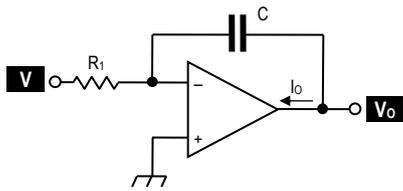
Corretto funzionamento:  $|V_o| < V_{SAT}$  ;  $|I_o| < I_{O\_MAX}$
