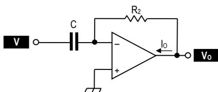
Corretto funzionamento:  $|V_O| < V_{SAT}$  ;  $|I_O| < I_{O\_MAX}$
